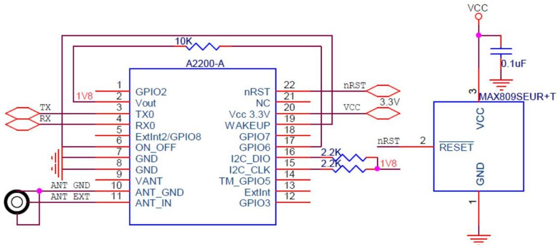
Une fois la carte réalisée, il nous faut trouver la longueur des antennes, le GPS possède deux ports antennes ANT\_GND et ANT\_IN, elles doivent être de la même longueur et être positionnées sur le même plan tout en étant parallèle.
