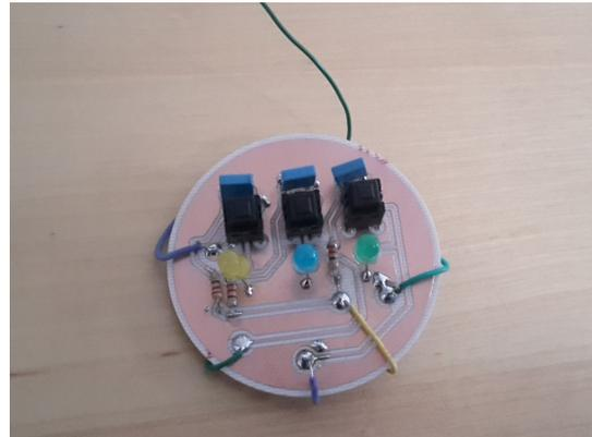
Le circuit est donc assemblé avec la Lilypad et fonctionne en toute autonomie grâce à la batterie externe. La Lilypad a une consommation en moyenne de 10 mA (réception, transmission et appui des boutons poussoirs) et donc avec une batterie d'une capacité de 2200mAh, nous pouvons obtenir une autonomie de 220 heures.
