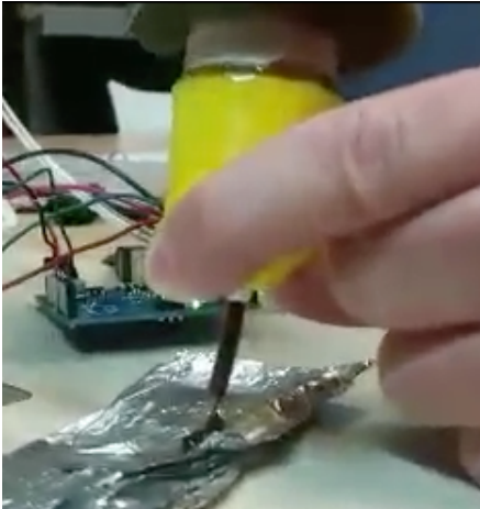
FIGURE 13 - TEST D'EXTRUSION DE CHOCOLAT
