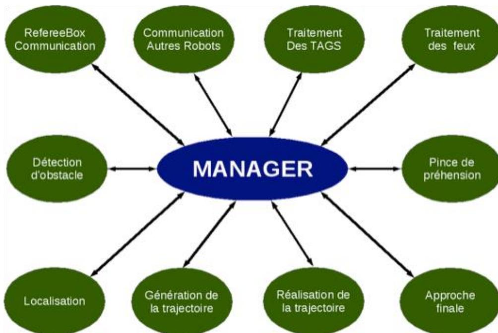
Le manager se découpe en deux parties : le générateur de tâches et les exécuteurs de tâches (un pour chaque robot). Le générateur traduira les commandes de la Referee Box, ordonnancera les tâches à réaliser et les communiquera à l'exécuteur de tâches correspondant. L'exécuteur de tâches, quant à lui, utilisera les autres nœuds afin de mener à bien la tâche demandée par le générateur de tâches.
