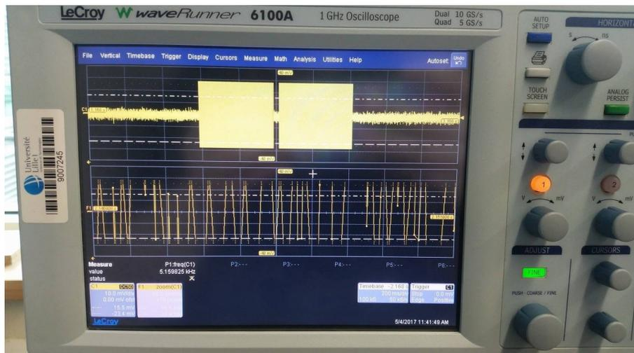
Image10 : Emission LoRa sans antenne patch
