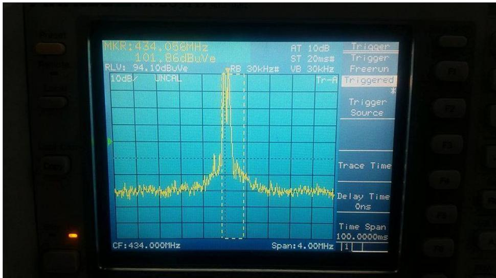
Image7 : Spectre du signal modulé en LoRa
