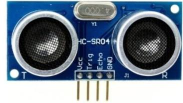
Figure 9 : Capteur ultrason HC-SR04
