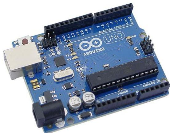
Figure 23 : Carte Arduino UNO, embarquant l'Atmega 328P
