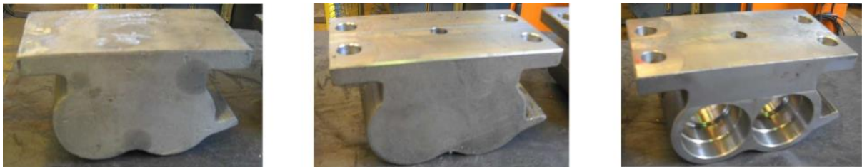
Figure 1: Exemple d'usinage de pièce en deux opérations
