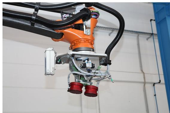
La pièce en sortie de la machine est stabilisée sur un support. Une ou plusieurs pièces sont attirées par l'aimant après magnétisation. Les pièces sont ensuite déposées dans le bac de conditionnement.
