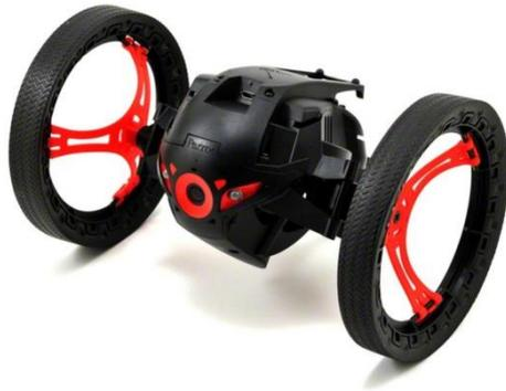
Ce drone a la capacité de se déplacer en roulant puis de sauter. Celui-ci sera commandé par wifi.
