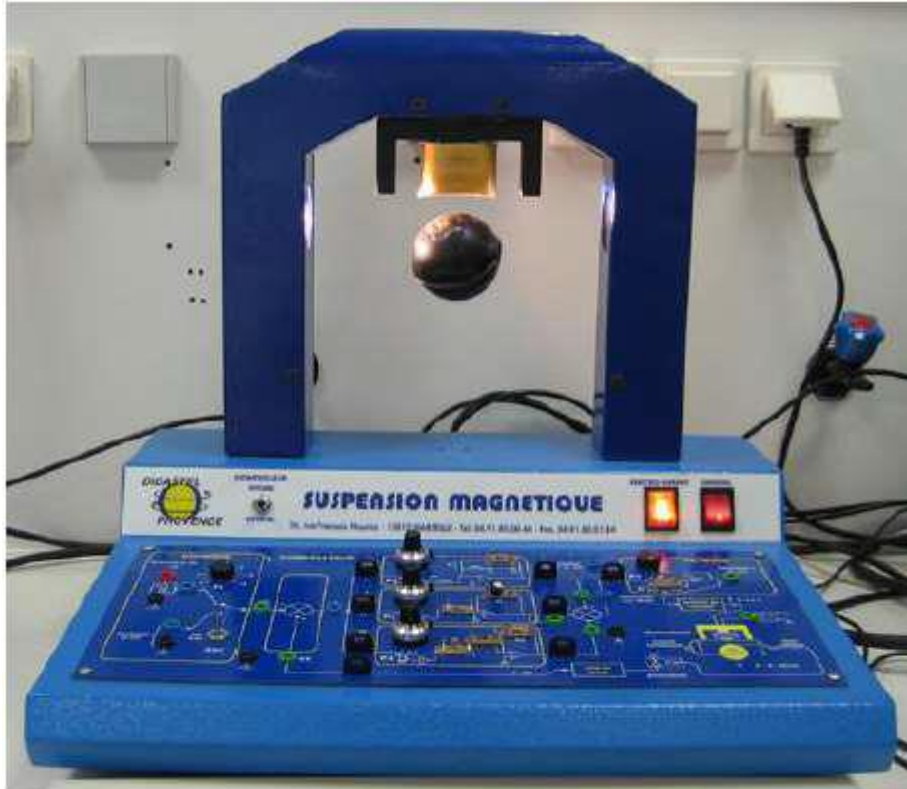
La suspension magnétique Didastel
