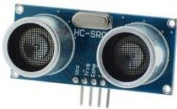
Le capteur ultrason utilisé dans notre projet permet de détecter la présence d'un véhicule à l'arrière du vélo.
