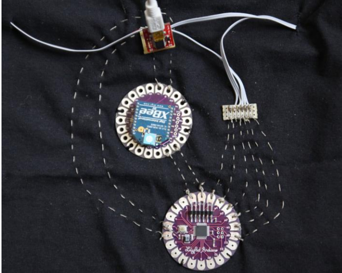
Le système à accrocher sur les vêtements, avec LilyPad, Xbee Alimentation et connexion de gants
