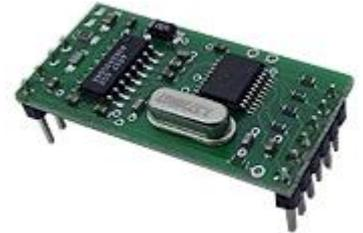
Le module fonctionne sur le principe du « auto-read », à savoir que tant qu'un TAG RFID est présent devant l'antenne, le flot de données est envoyé 2 fois par seconde sur le port série.
