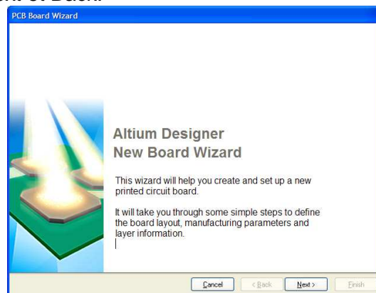
Figure 8 – Création d'un nouveau document PCB avec PCB Board Wizard
