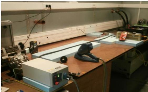
Figure 5.a: test sur alternateur alimenté
