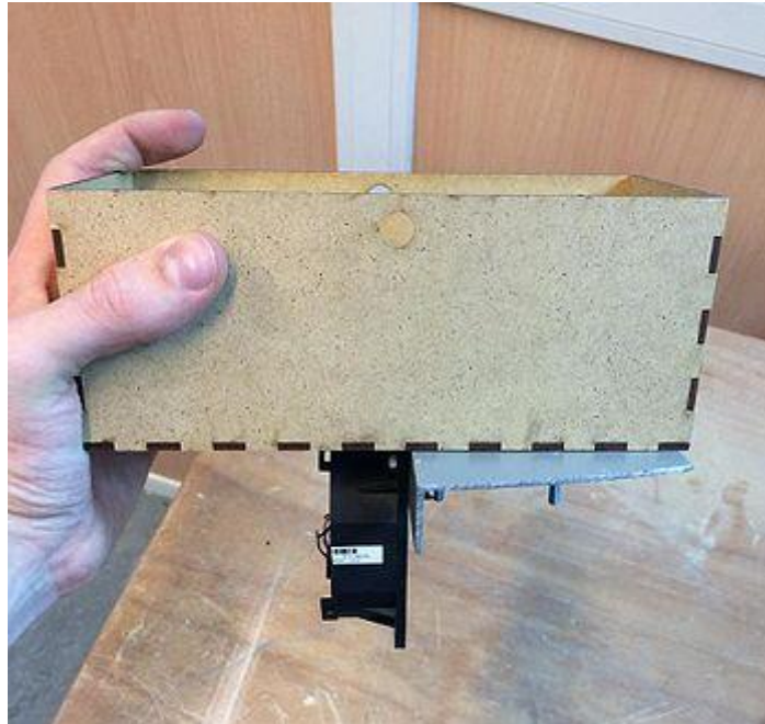
Nacelle allée à un seul ventilateur
