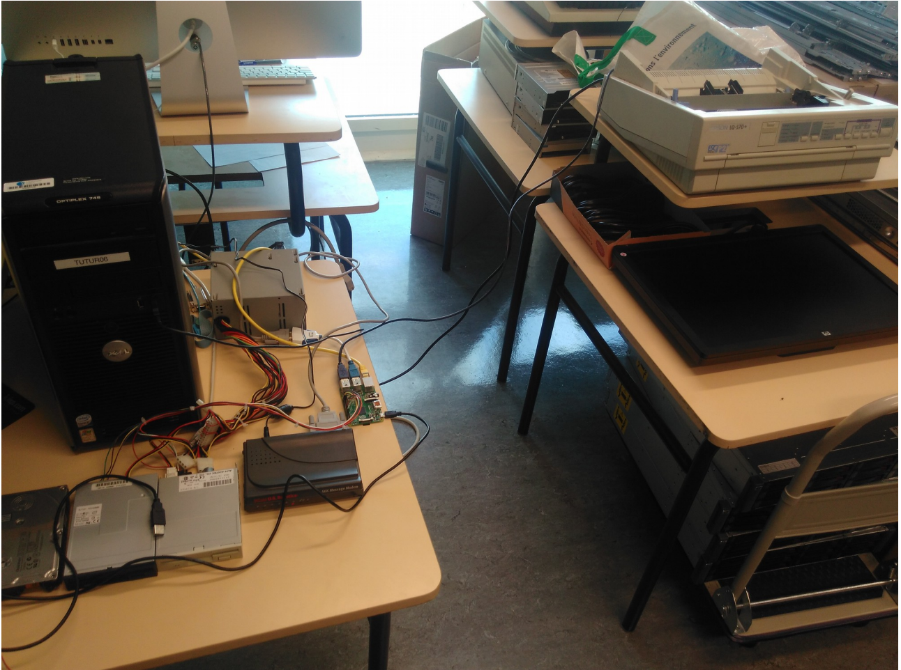
Montage final comprenant une RPI2 contrôlant un modem, les HDD, les FDD et l'imprimante matricielle
