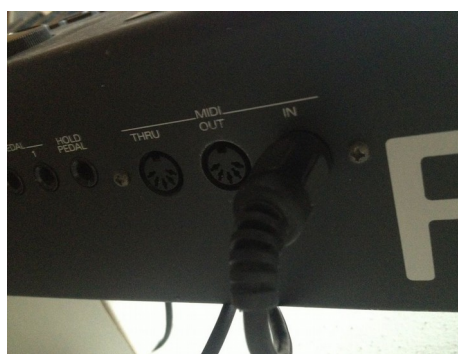
Exemple branchement MIDI sur clavier
