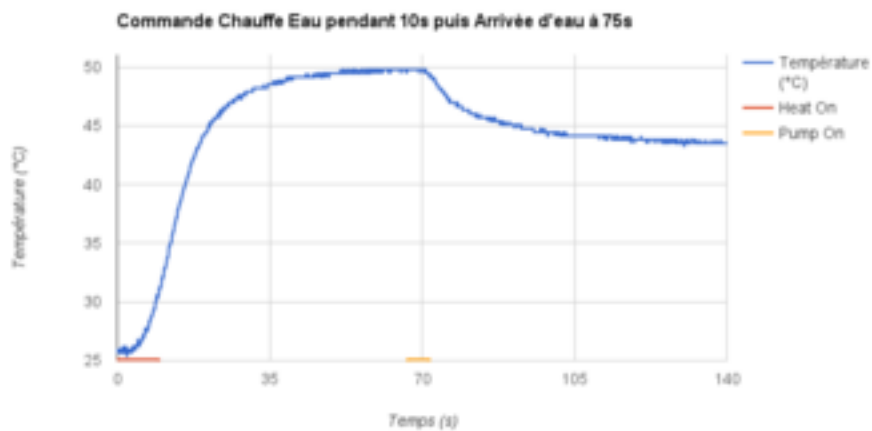
Réponse en température pour 10s d'alimentation, puis arrivée d'eau à t=75s
