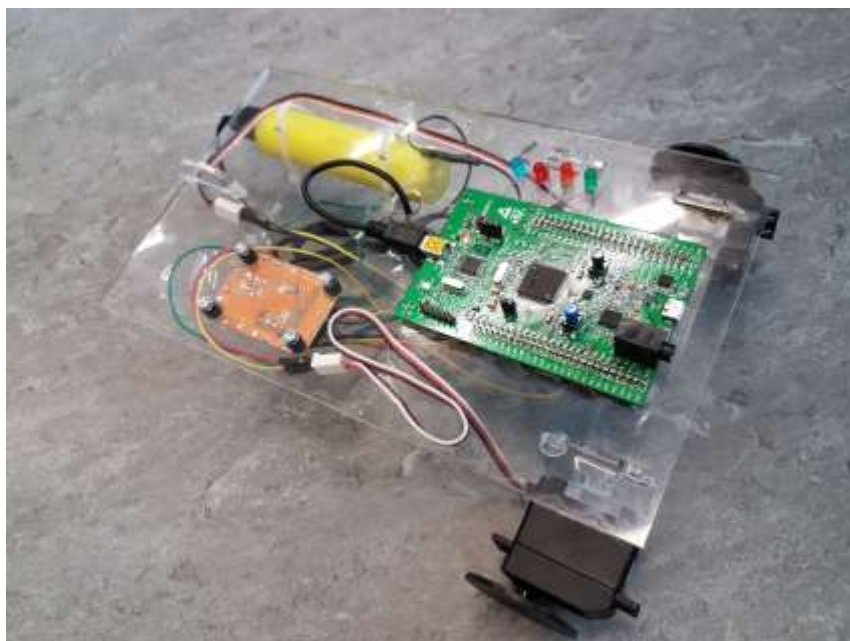
Annexe 9 : Robot réalisé à la découpeuse laser
