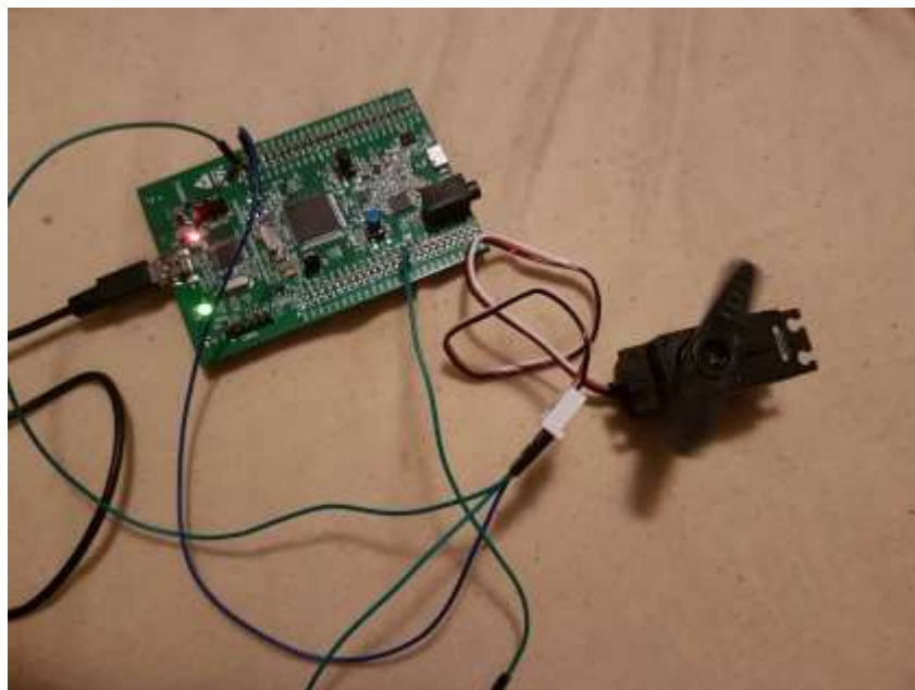
Annexe 2 : Pilotage d'un servomoteur depuis la carte STM32F4discovery
