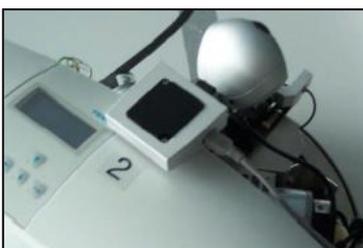
Le capteur NorthStar est fixé au Robotino au moyen d'une fixation de montage fournie. Pour calibrer, il suffit de saisir la distance entre le capteur et le plafond pour atteindre une précision de positionnement d'environ +/- 50 mm dans l'espace de travail.
