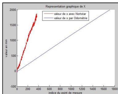
Il a fallu modifier le nombre de valeurs pour les calculs d'écart, car ces fonctions s'appliquent que sur des vecteurs de même taille. Donc il a fallu les retirer de façon logique ; ne pas garder que les première mais 1 sur 3, grâce à l'utilisation d'une boucle tant que.
