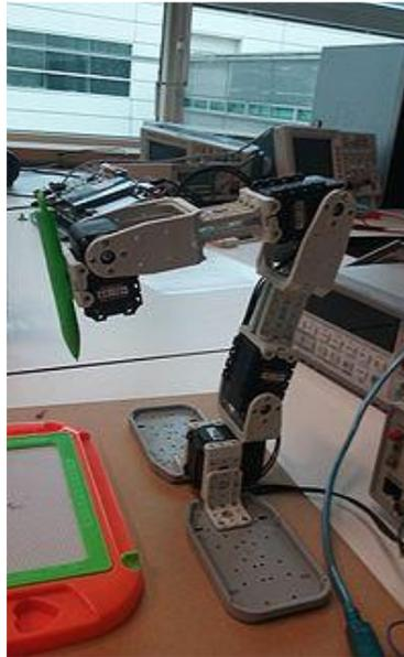
En plaçant un moteur à l'horizontale (le moteur le plus en bas), et les autres à la verticale, nous pouvions atteindre chaque point situé à une distance inférieure au bras tendu. Afin d'écrire sur l'ardoise magique, nous avons collé le stylet sur une pièce Bioloid, elle-même vissée sur le dernier moteur (moteur le plus haut).
