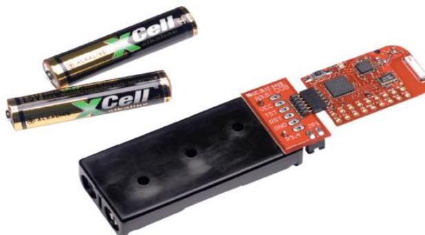
**Figure 2. Le support batterie du eZ430-RF2500**
