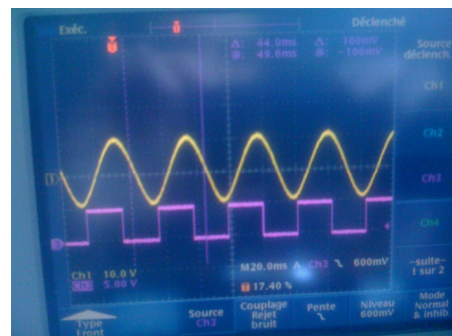
Allure de la tension et du déplacement x
