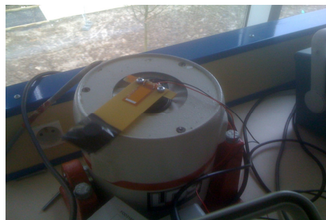
Fibre de verre+MFC encastrés sur le pot vibrant
