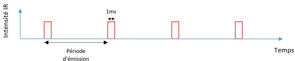
Figure 26 : Signal infrarouge émis
