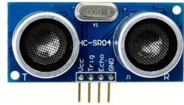
Figure 9 : Capteur ultrason HC-SR04
