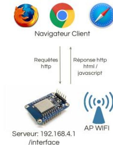
Figure 21 : Communication Navigateur/ESP
