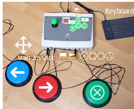
Figure 4 : Interface à contacteur sur une Dreamcast
