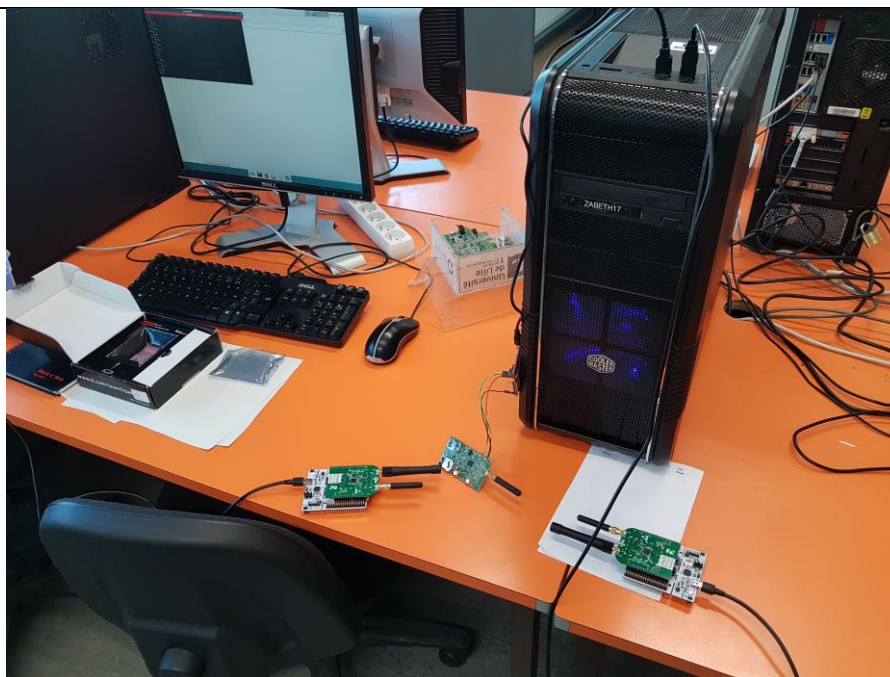
Montage pour tester le brouillage, avec deux terminaux ouverts pour observer le Ping Pong entre les modules LoRa
