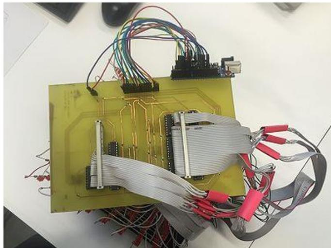
Sur l'image ci-dessus, est présentée la carte électronique conçue pour la matrice de LED (qui est ici juste en dessous de la carte électronique). Une des principales différences entre la carte électronique et mon schématic se trouve sur la non-présence de capacité de découplages au niveau de chaque démultiplexeur.
