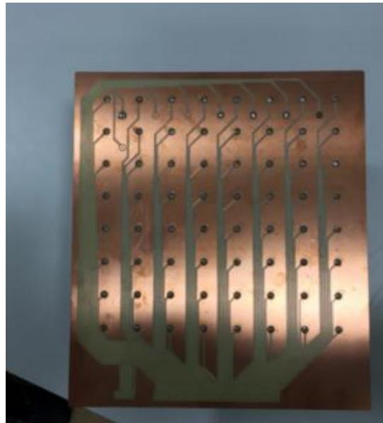
Comme on le constate sur les images ci-dessus, la matrice n'est pas terminée. La partie de la carte arduino n'a pas encore est installée par rapport au nouvel circuit imprimé. Sur la photo de droite, on voit sur le circuit imprimé d'un côté les 64 pistes menant aux cathodes de chaque led (sur chaque étage, il y a 64 leds). Tandis que de l'autre côté, on voit les 8 pistes menant aux anodes répartis sur les 8 étages de la matrice (une anode sur chaque étage de la matrice).
