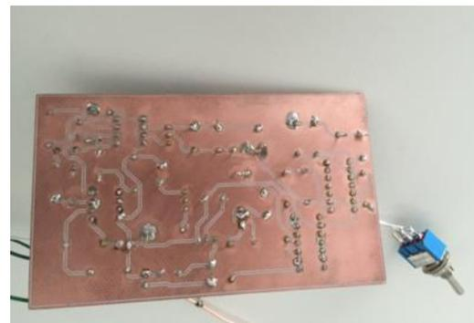
Cependant, après tests avec un multimètre, la carte électronique n'est pas fonctionnelle, sans doute dû à des bavures sur la carte électronique au moment du soudage des composants. C'est la raison pour laquelle, je n'ai pas effectué la liaison entre les deux cartes électroniques.
