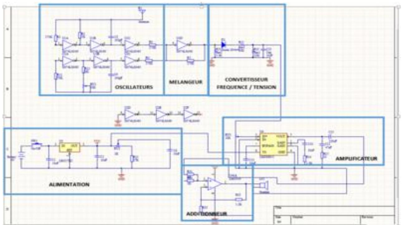
Dans la partie Oscillateurs se trouve un oscillateur qui génère une fréquence variable issue de l'antenne ainsi qu'un oscillateur qui va générer une fréquence fixe (ici, fréquence de référence - voir schéma du théremin plus haut dans le sous-projet). Ces deux signaux (de l'ordre de
