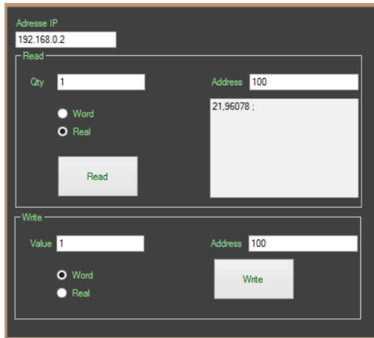
Figure 13: Aperçu de Nmodbus
