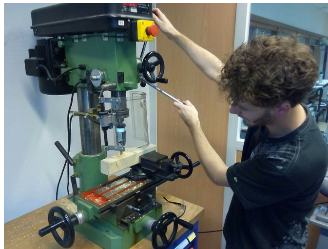
Figure 1 : Usinage des pylônes à la perceuse à colonne
