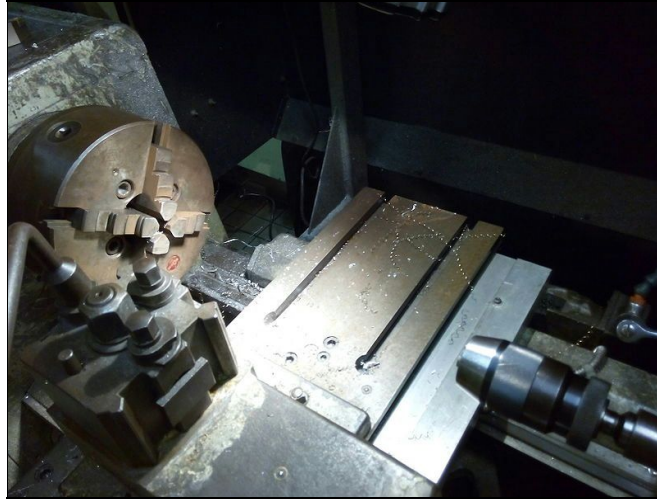
Figure 2 : Tour conventionnel utilisé pour le perçage
