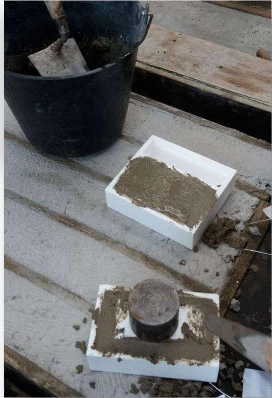
Image 12 : Coulage du béton dans les moules
