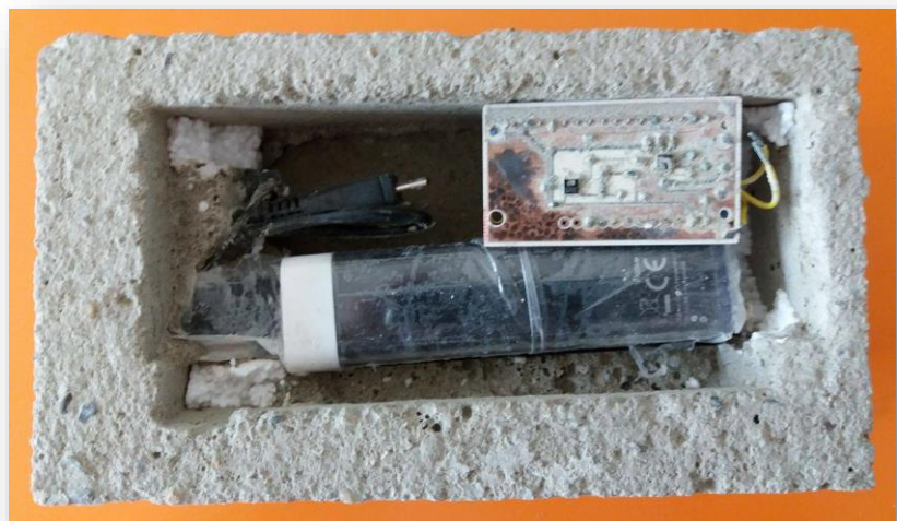
Image 13 : Résultat du test en situation réelle (carte de mesure oxydée)
