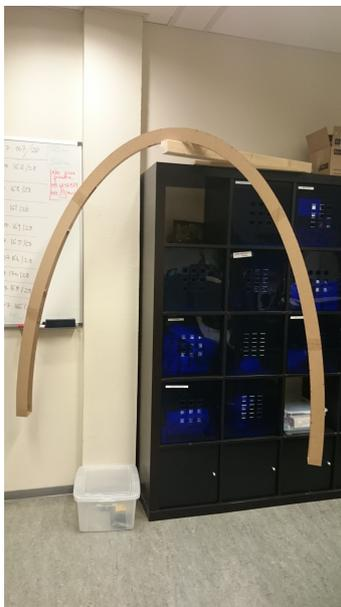
Figure 11: Maquette en carton échelle 1 de l'arche
