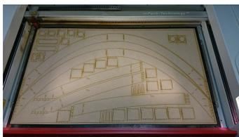
Figure 12: Une plaque sortant de la découpe laser
