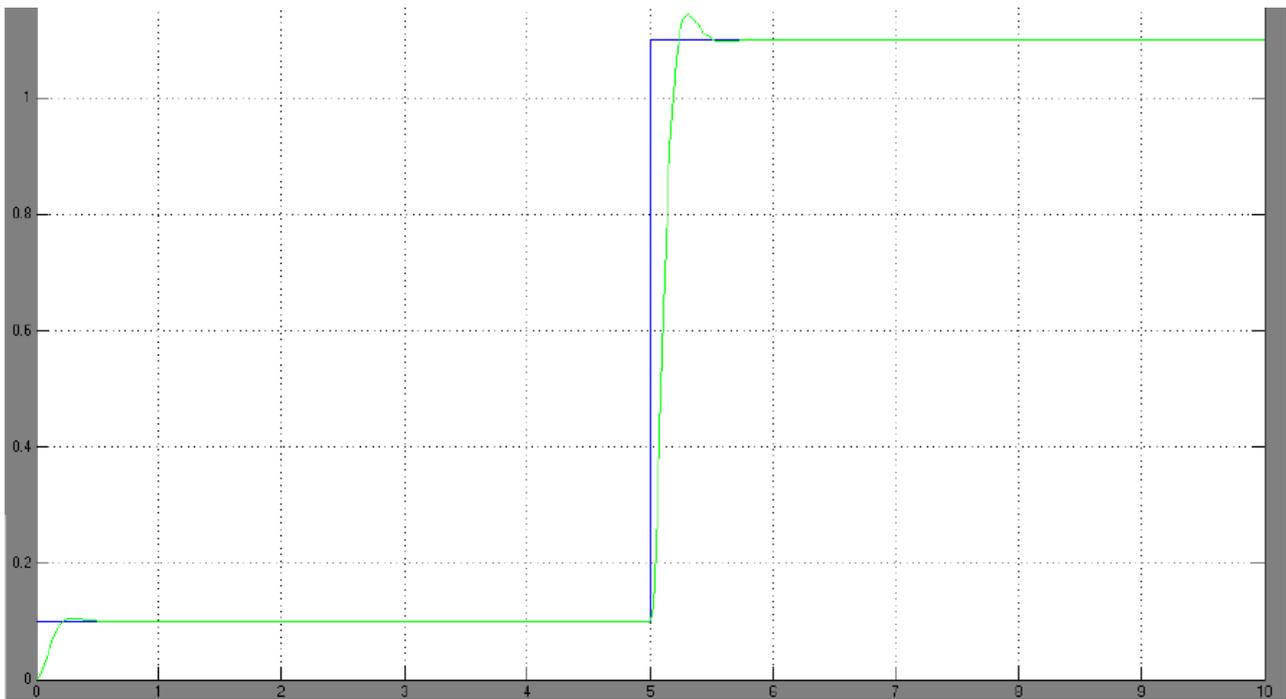
On voit que le placement des pôles est assez efficaces, le système est stable et régit rapidement, le fait d'avoir multiplié par 5 les parties réelles ne demande pas non plus un gros effort au système. Les parties imaginaires nulles permettent bien d'avoir un très faible dépassement et d'annuler les oscillations.
