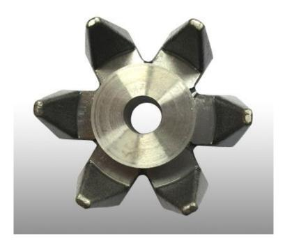
On mesure la conductivité électrique de ces roues polaires car elle est associée aux pertes par courant de Foucault. Les courants de Foucault ont pour effet d'écranter le champ magnétique (effet de peau) et de dissiper de l'énergie (effet Joule). Ces courants vont donc diminuer les performances de l'alternateur.
