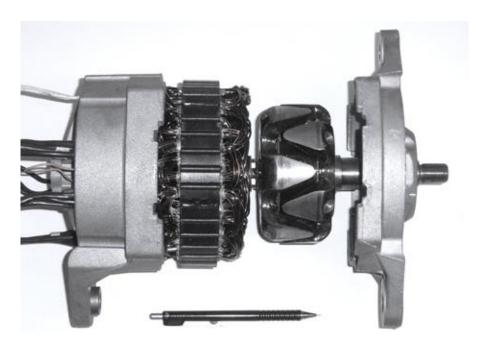
L'alternateur à griffes présenté ci-dessus est une machine synchrone triphasée. Cet alternateur peut être utilisé dans le secteur automobile. Son rotor est entraîné par une courroie
