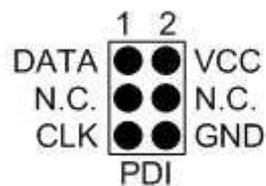
Il se compose d'une broche d'alimentation (3.3V), d'une patte pour les données et une pour l'horloge.
