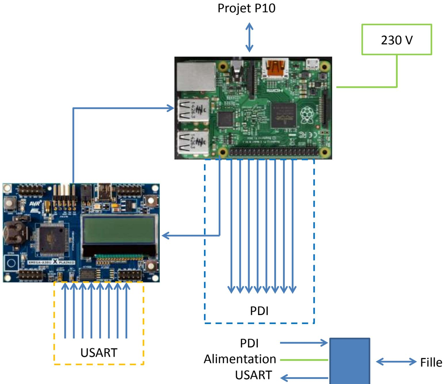
Le nœud reconfigurera directement avec le PDI la carte fille. On remontera les informations via l'USART. La carte sur laquelle on aura la liaison série nous permettra d'estimer la consommation du nœud. La connexion avec la carte fille s'effectuera par un câble RJ45.
