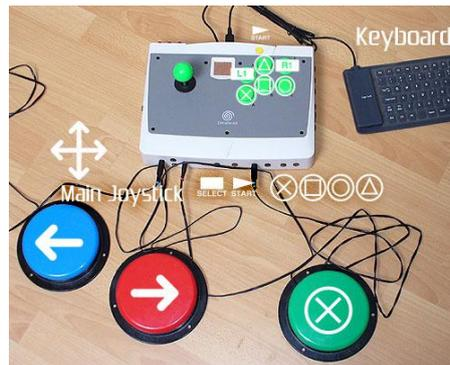
Figure 4 : Interface à contacteur sur une Dreamcast
