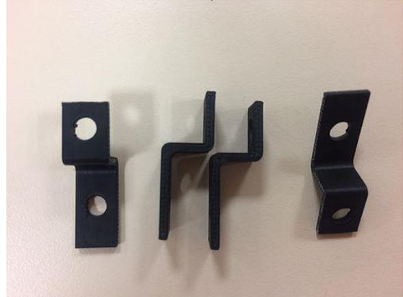
Figure 10b: Pièces 3D imprimées
