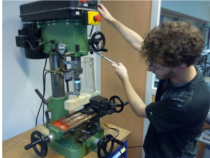
Figure 2 : Usinage des pylônes à la perceuse à colonne
