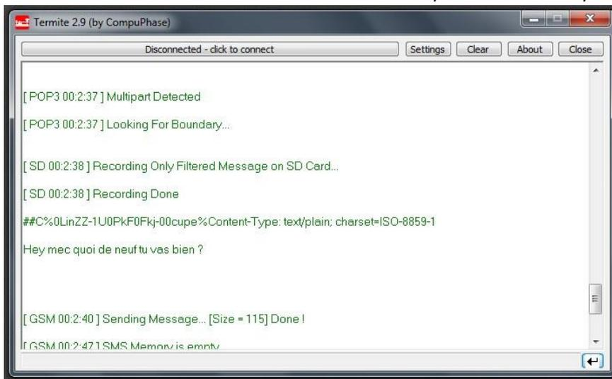
Un aperçu du terminal série permettant de suivre en temps réel l'activité de l'Arduino
