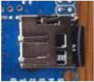
Comme nous avons pu le voir sur la photo du « Shield Ethernet » ce dernier comporte un port pour carte microSD. En effet la RAM de l'Arduino MEGA 2530 ne faisant que 8 Ko cela est trop peu pour pouvoir manipuler de grandes chaînes de caractères correspondant aux entêtes et au corps des emails non filtrées. La base de travail sur la carte SD a été la librairie « SD Library » Arduino qui permet de manipuler la carte facilement en faisant abstraction de la gestion du system de fichier.
