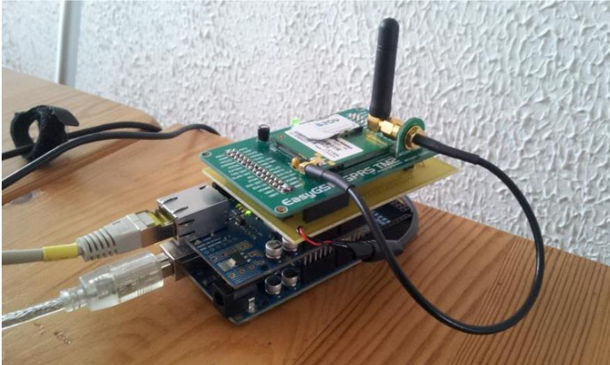
Montage à base d'Arduino MEGA complet avec le Shield Ethernet, Le module GSM et entre les deux la carte d'adaptation réalisée pour le projet.
