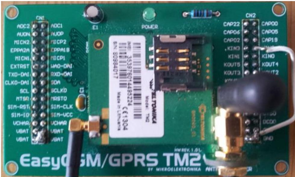
Le système ne serait pas complet sans le module permettant d'envoyer des SMS. C'est un module TM2 monté sur une platine de connectique EasyGSM de Mikroelektronika. Il peut réaliser toutes les fonctions de base d'un téléphone à savoir SMS, Voix et Internet. Il dispose de plusieurs dispositifs de communications. Nous nous intéresserons ici uniquement à sa liaison série qui permet de commander via les commandes AT.
