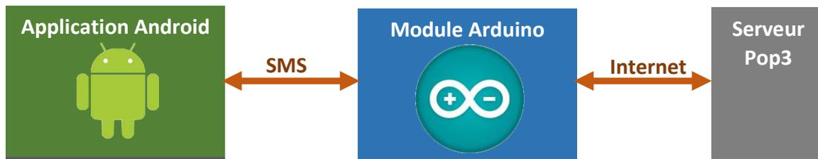
L'objectif du module Arduino est d'effectuer une lecture d'emails sur un serveur distant en se connectant de manière autonome au réseau internet. De plus il devra transmettre les données récoltées à un téléphone Android uniquement par l'envoi et la réception de SMS.
